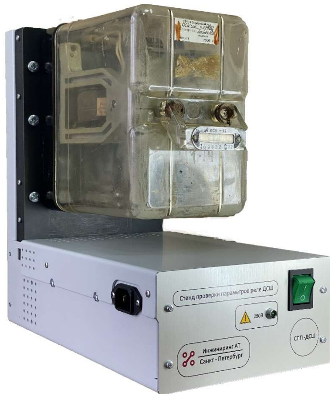
Модуль измерения с установленным реле ДСШ
