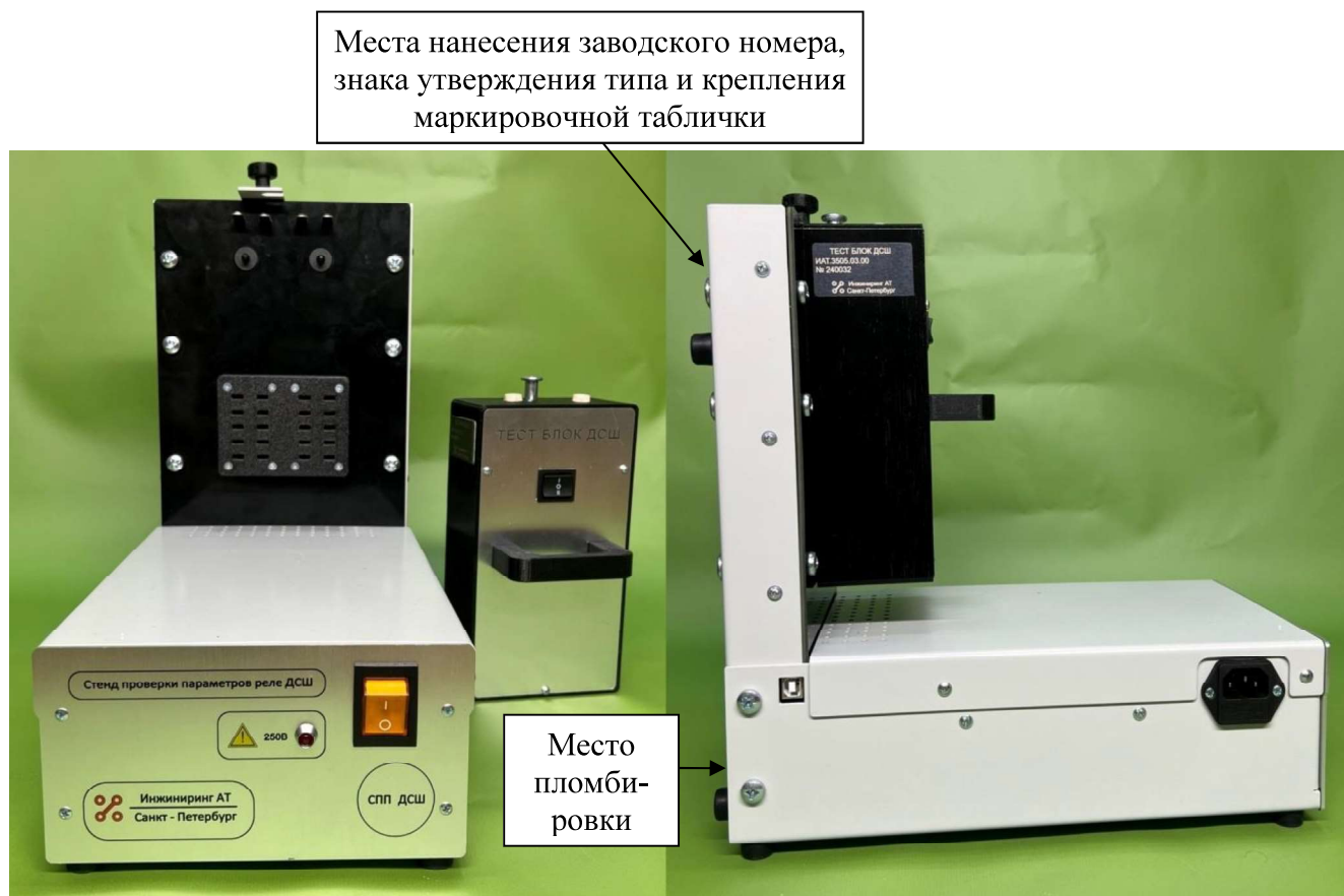
Рисунок 1 – Внешний вид стенда СПП ДСШ, места нанесения заводского номера, знака утверждения типа, пломбировки и крепления маркировочной таблички
